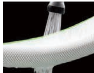
3D 매쉬와 입체 구조의 폴리에틸렌의 물 투과 장면 두 소재 모두 흡습성이 적어 물을 흡수하지 않고 거의 그대로 통과시킨다.
