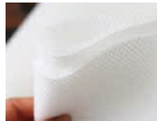
3D 매쉬의 구조 매쉬 조직(그물망과 같은 조직)으로 짠 직물과 직물 사이에 가느다란 폴리에스터 실이 촘촘히 채워져 위와 아래의 매쉬 직물을 연결한 구조로 되어 있다.
